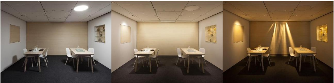
Abb. 2: Beispielhafte Darstellung verschiedener Beleuchtungskonzepte im Studio der Bartenbach Lichtwelt in Aldrans; Links: diffuse Raumbelichtung mittels eines Deckenpanels, Mitte und Rechts: architekturintegrierte Beleuchtung mittels Bartenbach Components mit unterschiedlichen emotionalen und melanopischen Wirkungen)
