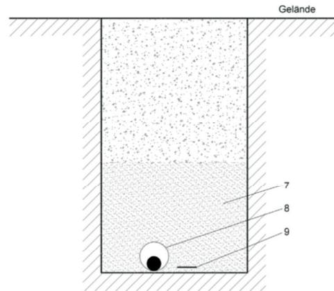
ABB. 2.2 – Verlegung des Erders bei Verwendung von Kabelschutzrohren
