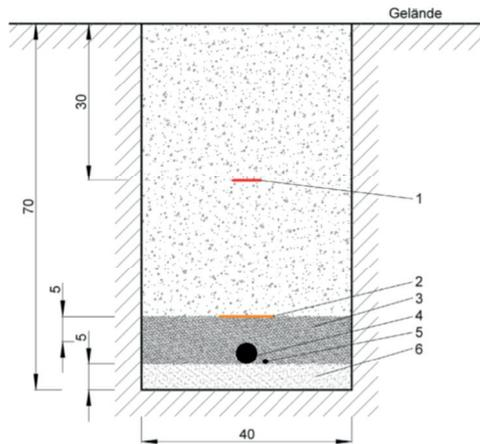
ABB. 2.1 – Erdverlegung des Erders im Nahbereich der Kabel-/Leitungsanlage
