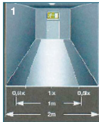
Bild 1 und 2: Mindestbeleuchtungsstärke und Gleichmäßigkeit in Rettungswegen
