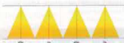
In Rettungswegen mit einer Breite bis zu 2 m muss die Mindestbeleuchtungsstärke entlang der Mittellinie 1 lux erreichen und im Mittelbereich zumindest 0,5 lux betragen. Die Gleichmäßigkeit der Beleuchtungsstärke in der Mittellinie des Rettungsweges darf dabei das Verhältnis 2:1 nicht überschreiten.
